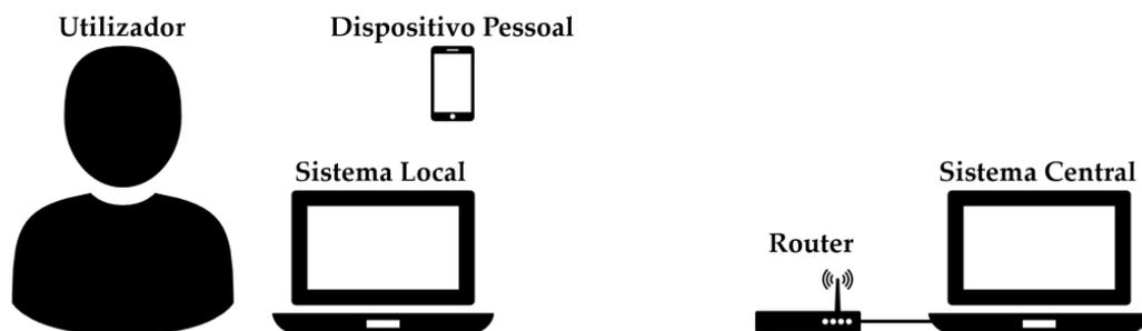
Figura 5.1: Diagrama da montagem dos testes de usabilidade. O sistema central está ligado por cabo ao *router* e os restantes dispositivos estão ligados via *Wi-Fi*. Para sistema central usou-se um *Lenovo ideapad 110*, para sistema local um *Lenovo Y50*, para *router* usou-se um *Conceptronic C300BRS4A* e para dispositivo pessoal do utilizador um *smartphone, tablet, portátil ou computador pessoal*
